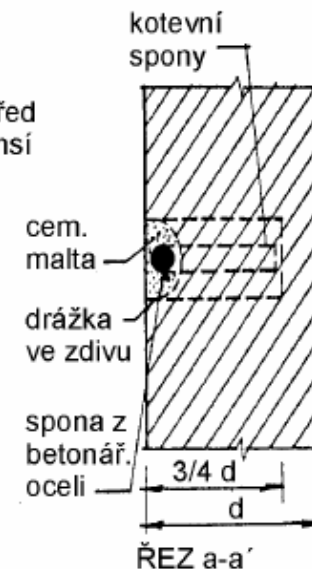
• Schema osazení spon ve zdivu
